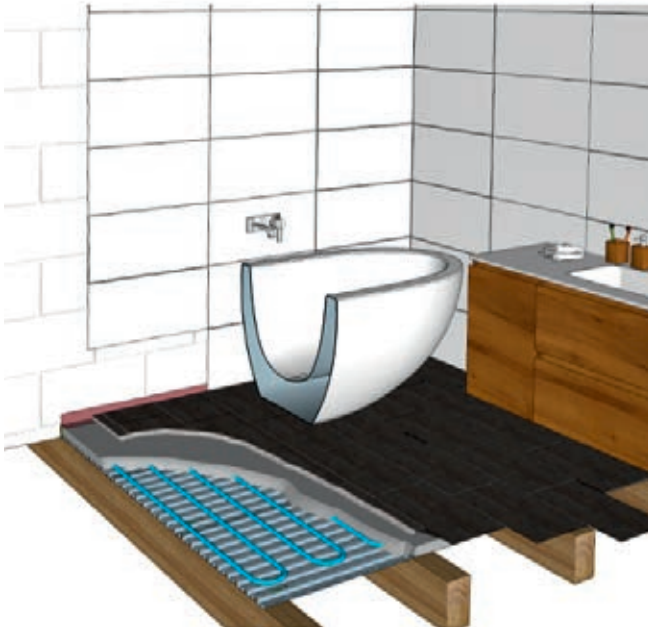
Badezimmerboden mit wasserbeständigem Randanschluss am bestehenden Mauerwerk
